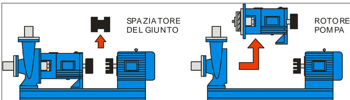
Figura 10 Esecuzione back pull out
