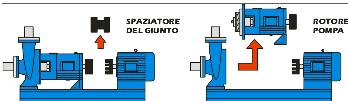
Figura 10 Esecuzione back pull out
